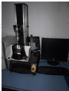
Přístroj pro měření pevnosti dužniny na pracovišti Instytut Ogrodnictwa Skierniewice (Polsko)
