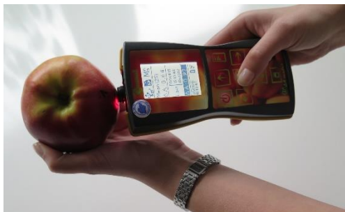
Měření stupně zralosti DA metrem u odrůdy 'Melrose Beaumon'
